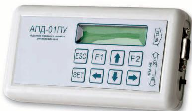
Адаптер переноса данных предназначен для работы совместно с теплосчетчиками ТЭМ.
